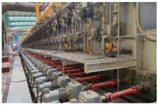
淬火机 - 东北大学 (高压段辊道、低压段辊道)
